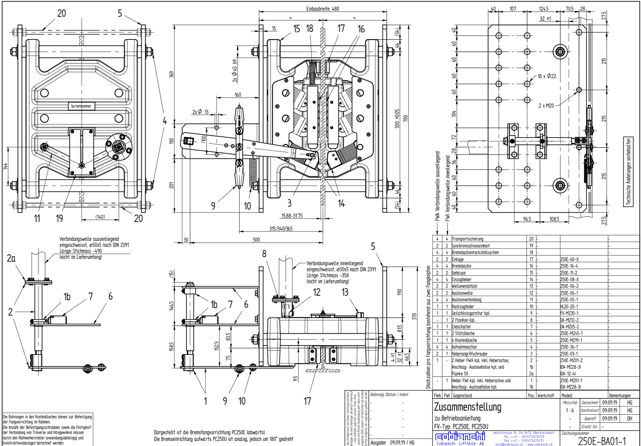
Die Bohrungen in den Knotenblechen dienen zur Befestigung der Fangvorrichtung im Rahmen.
